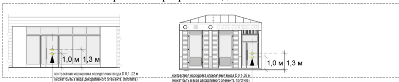
Рис. «Внешний вид контрастной маркировки входа»
