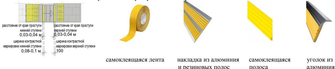
Рис. «Внешний вид контрастной маркировки на ступенях»
